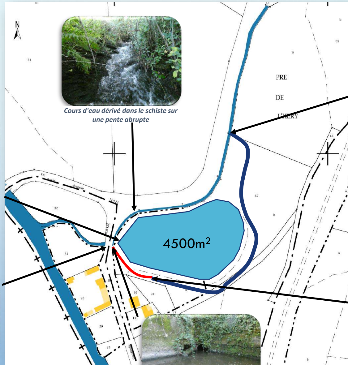
Déversoir et aval cours d'eau dérivé hauteur de chute 1,40m
